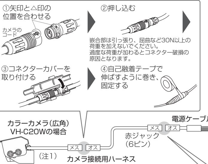
(注1) カメラ背面のカメラケーブルを30N以上の荷重で引っ張らないでください。
