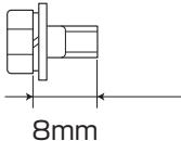
防水性を確保するためにカメラケースのねじ穴部は袋構造になっています。長いボルトを無理に使用するとねじ山およびカメラケースが破損し、防水性が保てなくなります。
