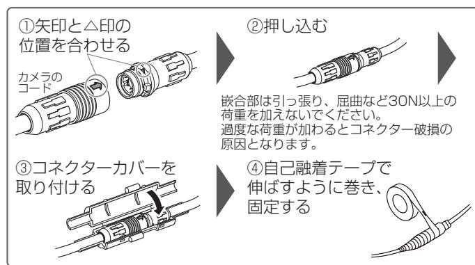
(注1) カメラ背面のカメラケーブルを30N以上の荷重で引っ張らないでください。
