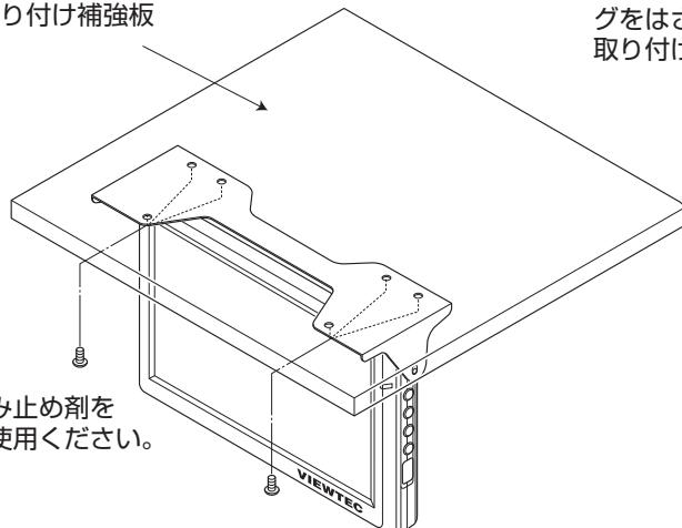
液晶モニターの室内取り付け部は、ヘッドライニングをはさんで、裏側より取り付け補強板を当てて、取り付けます。
